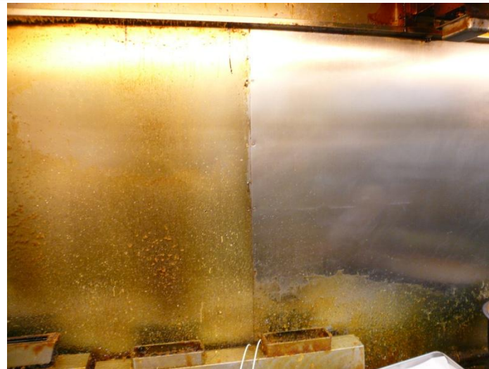
施工面と清掃のみで6ヶ月放置したテスト
